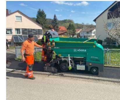
E-Fertiger Prototyp (Vögele Mini 500e)
