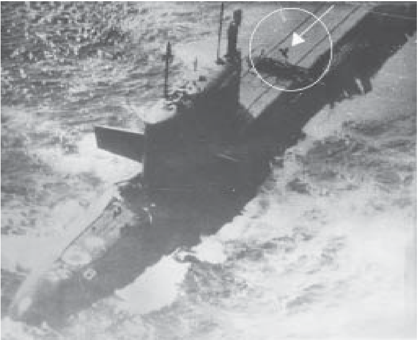
На снимке: К-219 за несколько часов до гибели. Снимок с вертолета. Видна разрушенная ракетная палуба в районе взрыва в ракетной шахте. (Из архива Николая Мормуля)
