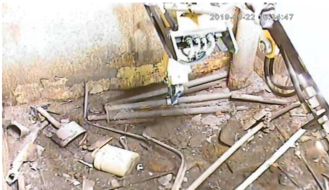
Обращение с ОТВС на дне бассейна.
