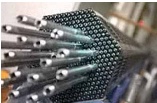
Рис. 2.2. Тепловыделяющая сборка ВВЭР 1000.
