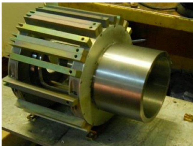
Рис. 3. Окончательный вариант магнитной системы ЦПЭ.
