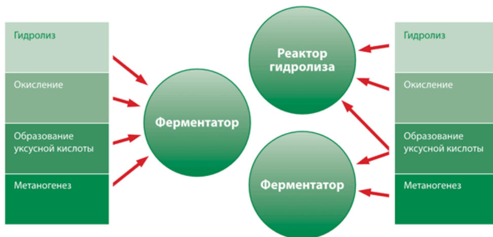
Рисунок 3 - Одно- и двухстадийная технология добычи метана.
