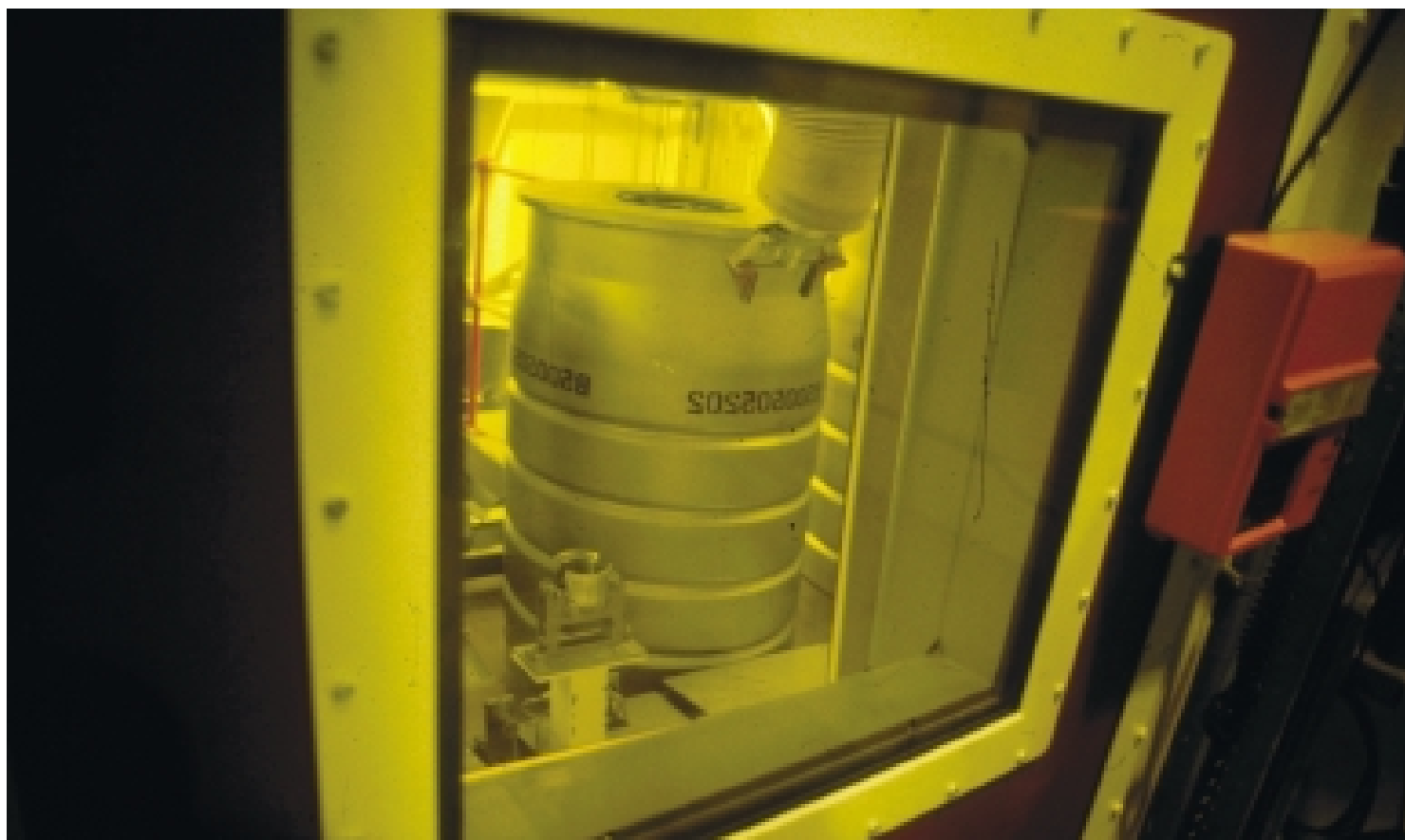
Høyaktivt flytende atomavfall glassifiseres og lagres i slike ståltønner.
