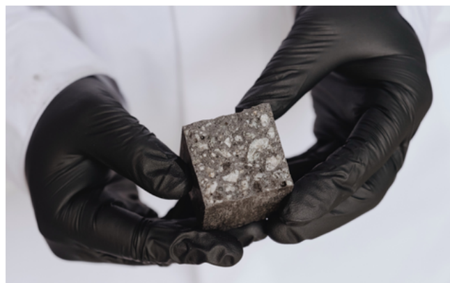
Bilde: Betong laget av gruveavfall (Oioioi /Cemonite)
