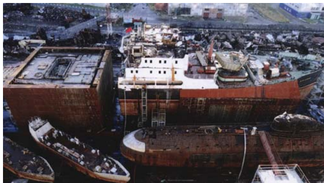
Рис. 11. Формирование кормовой блок-упаковки
